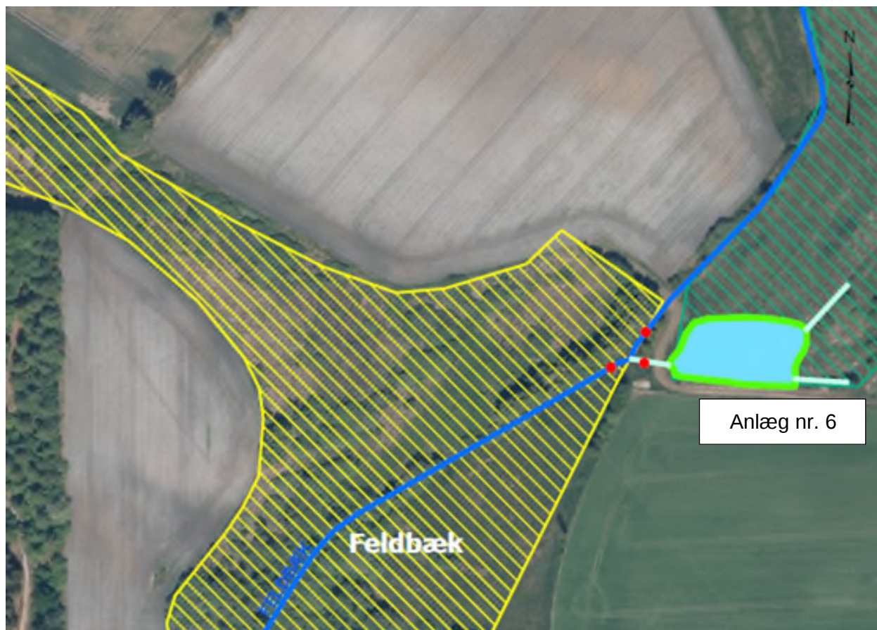
Figur 2. Projekttegning af okkerbassin. Lyseblå markering angiver det planlagte projektområde. Gul markering angiver §3 mose, mens grøn markering angiver §3 eng.
