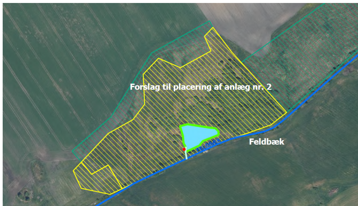
Figur 2. Projekttegning af okkerbassin. Lyseblå markering angiver det planlagte projektområde. Gul markering angiver §3 mose, mens grøn markering angiver §3 eng.
